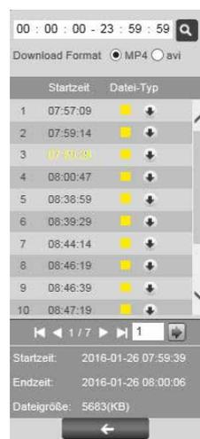
Durch einen Doppelklick auf einen Eintrag (Startzeit) werden unten in der Liste die Start- und Endzeit der Aufnahme sowie die Dateigröße angegeben. Außerdem wird durch die Farbcodierung die Art der Aufnahme kenntlich gemacht (im Beispiel links: gelb = Bewegung).
