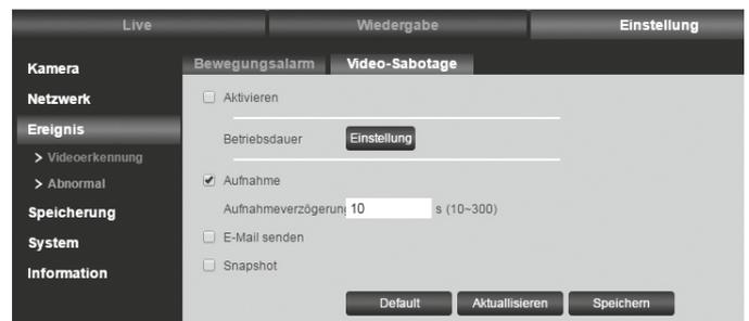
Hier können Sie festlegen, was im Falle einer erkannten Kamera-Sabotage geschehen soll, die z. B. durch eine Verdrehung oder Verdeckung der Kamera ausgelöst wurde. Im Prinzip verfahren Sie hier genau so wie bei den Einstellungsoptionen, die zuvor für den Bewegungsalarm beschrieben wurden.
