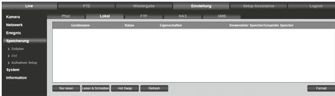
Um Aufnahmen/Snapshots auf der SD-Karte der Kamera speichern zu können, legen Sie zuerst eine Mikro SD-Karte in die Kamera ein. Anschließend ist es wichtig, die SD-Karte zu formatieren. Klicken Sie hierfür auf „Format“.
