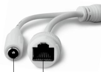
12 V DC Betriebsspannung    Netzwerk
