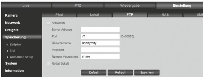
Um Dateien auf dem FTP-Server zu speichern, setzen Sie bitte ein Häkchen bei „Aktivieren“. Geben Sie die Parameter des FTP Servers ein. Stellen Sie sicher, dass sich der FTP-Server und das Gerät im gleichen Netzwerk befinden.
