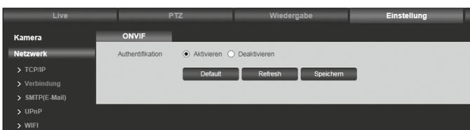
Diese Kamera ist ONVIF-kompatibel. Diese Kompatibilität ermöglicht die Konfiguration und Einbindung der Kamera in die meisten am Markt bekannten Videomanagement-Lösungen.
