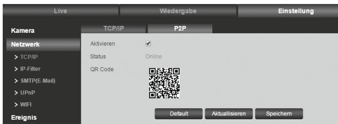
Um auf Ihre Kamera per App von unterwegs zugreifen zu können, müssen Sie die Kamera in ein Netzwerk einbinden, welches Zugriff auf das Internet hat. Wenn Sie nun die P2P Funktion aktivieren, stellt die Kamera eine Verbindung zum Burg-Wächter P2P Server her. Bei erfolgreichem Verbindungsaufbau wechselt der Status binnen einer Minute auf „Online“. Die Kamera kann anschließend in Ihre App eingebunden werden.
